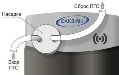
Рисунок Е.1 – Установка насадки для подачи ПГС
