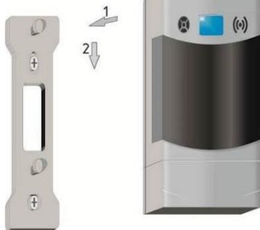
Рисунок 3 – Установка сигнализатора на монтажную панель
